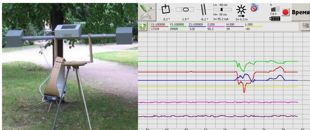
Рисунок 11. Аппаратура и дисплей аппаратуры электромагнитного диагностирования трубопроводов АЭМД
