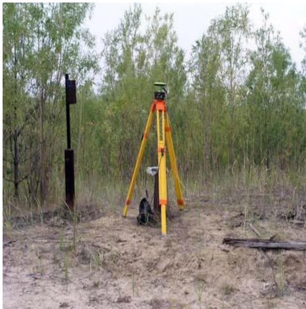
Рис.9 Спутниковый приемник на репере
